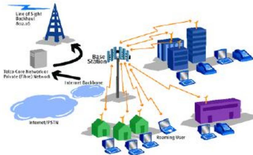
Fig. 1.21: architettura rete WIMAX
