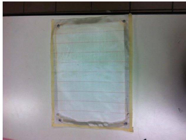
Figura 3.4: posizionamento del peel-ply
