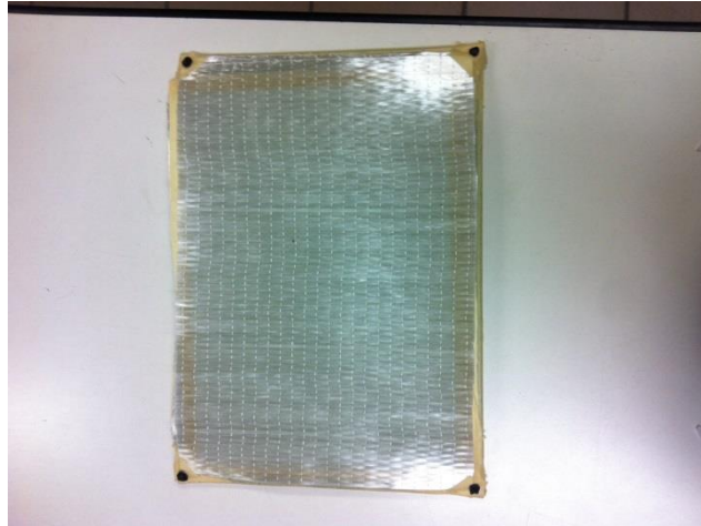
Figura 3.3: posizionamento del rinforzo
