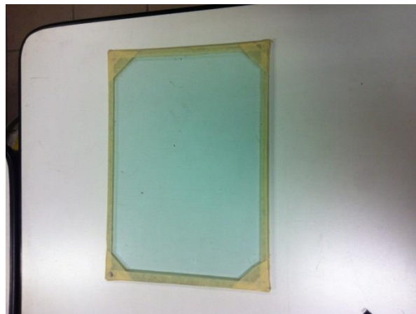
Figura 3.2: immagine dello stampo ricoperto dal distaccante
