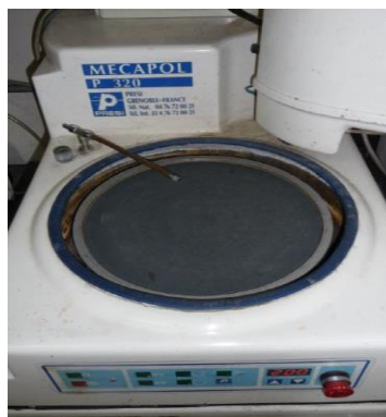
Figura 4.1: levigatrice orbitale MECAPOL P320 prodotta dalla PRESI
