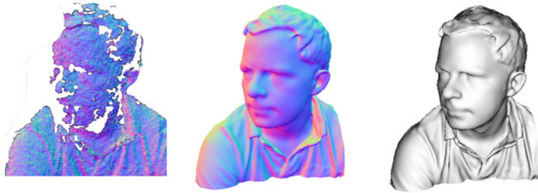
Fig. 1.1: Modello 3D eseguito con KinectFusion
