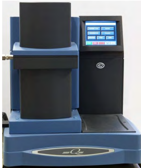
Figura 4.15 DMA Q800 della T.A. Instruments
