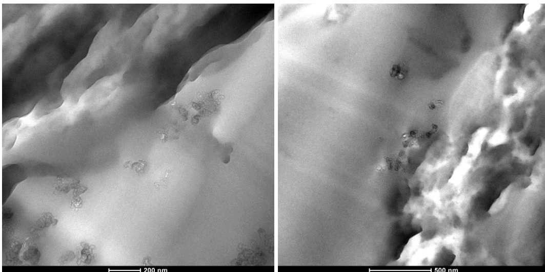
Figura 6.50 Immagini TEM del composito PC-ABS + 1 % Nerofumo prodotto per estrusione Particelle di nerofumo in corrispondenza dell'interfaccia tra PC e ABS
