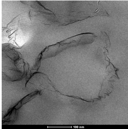
Figura 6.40 Immagini TEM del PC-ABS + 1% Grafene – evaporato foglietti di grafene
