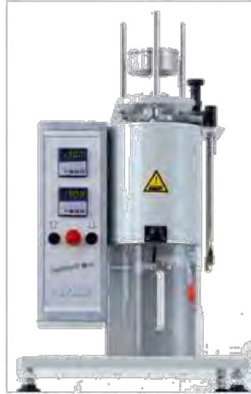
Figura 4.20 Strumento per la misura del melt flow index
