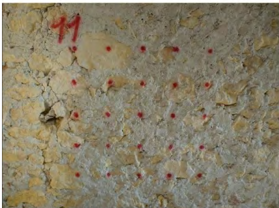
Disposizione griglia ACCELEROMETRO
