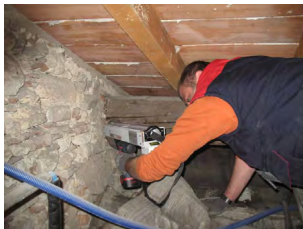
Fig. 2.3. 13 - Prove resistografiche refettorio (prove pregresse, Museo Archeologico)
