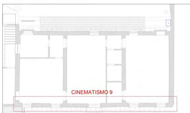
Fig. 4.4. 17 - localizzazione e schema cinematismo 9
