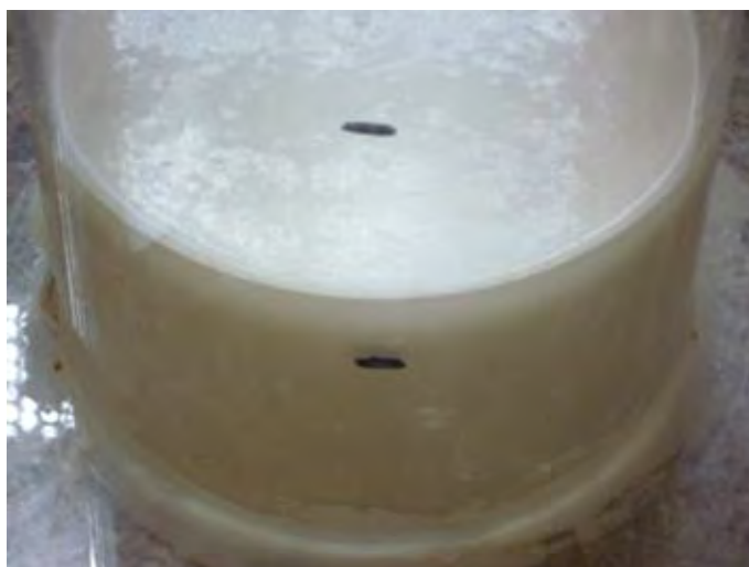
Fig. 2.4. 64 - Prova di stabilità miscela Kerakoll (Museo Archeologico)
