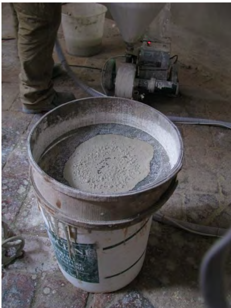
Fig. 2.4. 57 - Osservazione della miscela dopo l'iniezione campo prova 3 (Museo Archeologico)
