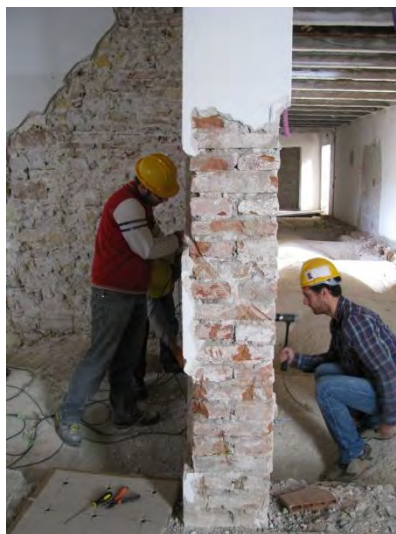
Fig. 2.4. 3 - Esecuzione della prova sonica diretta (Museo Archeologico)
