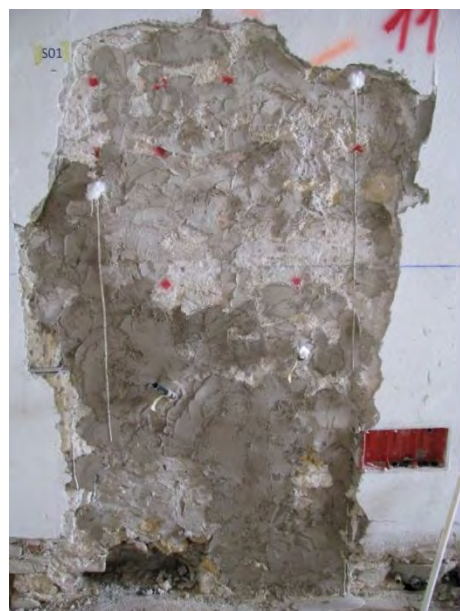
Fig. 2.4. 47 Campo prova 1 iniettato (Museo Archeologico)
