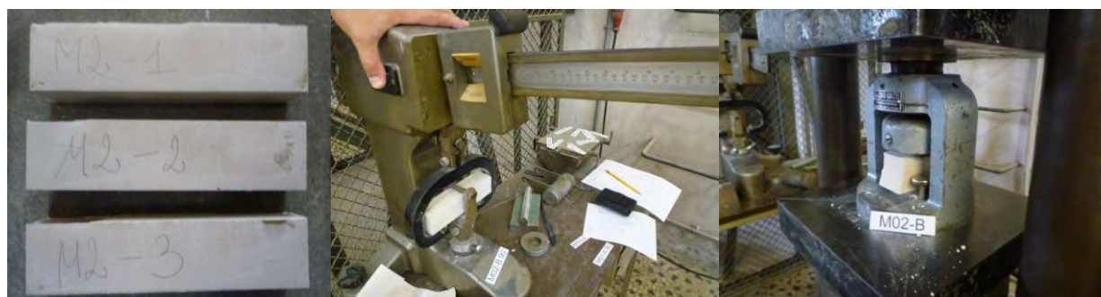
Fig. 2.4. 66 - Campioni di miscela testati, Prova a flessione, Prova di compressione (Museo Archeologico)
