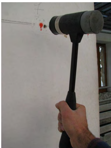
Fig. 1.1. 11 - Martello strumentato (Museo Archeologico di Verona)
