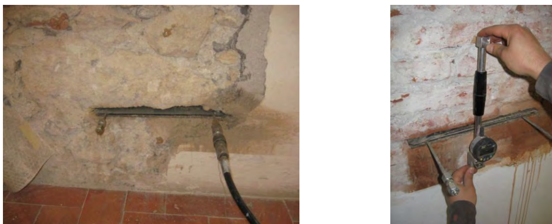
Fig. 2.3. 3 - Martinetti piatti singoli n.9 e n.10 (prove pregresse, Museo Archeologico)
