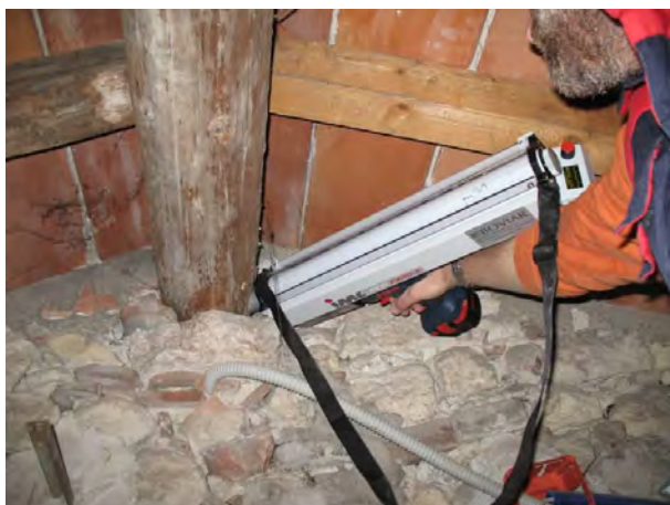
Fig. 2.3. 13 - Prove resistografiche refettorio (prove pregresse, Museo Archeologico)
