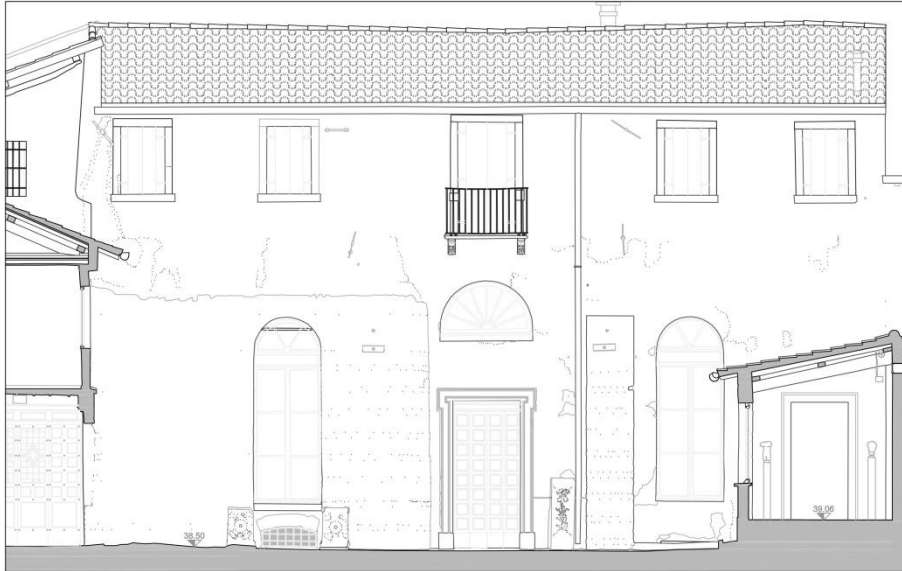
Fig. 4.4. 5 - quadro fessurativo facciata sud refettorio
