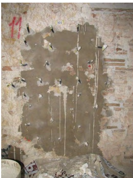
Fig. 2.4. 47 Campo prova 1 iniettato (Museo Archeologico)
