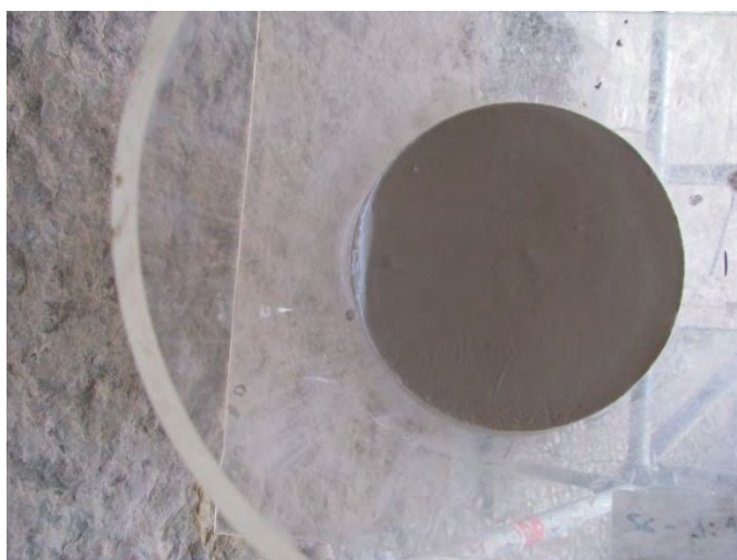
Fig. 2.4. 63 - Prova di stabilità miscela Albaria (Museo Archeologico)
