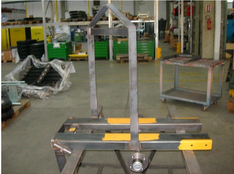
*Figura 5.4 – Telaio semilavorato costruito mediante operazioni di saldatura, prima del reengineering dei componenti*
