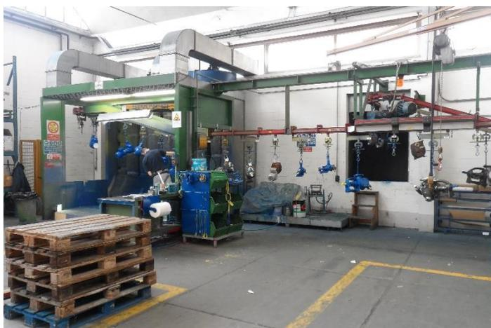
*Figura 4.14 – Impianto di verniciatura a tunnel con 80 ganci*
