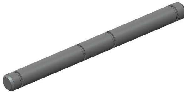
Fig. 3.35: Albero \varnothing 4\text{mm} del sistema paratoia
