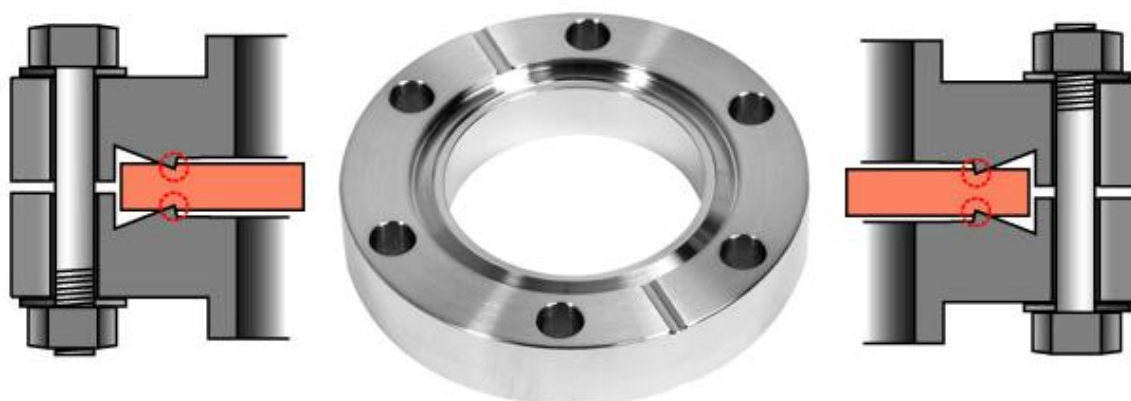
Fig. 3.46: Rappresentazione di una flangia CF e la schematizzazione della connessione fra due flange
