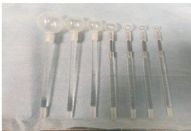
Figura 28 – le 7 sfere cave di volume interno da 16 a 0.25 ml prima del riempimento.
