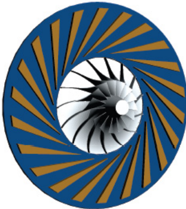
Fig. 125 - Vista prospettica dello stadio ottimizzato – massimizzazione Rapporto di Compressione
