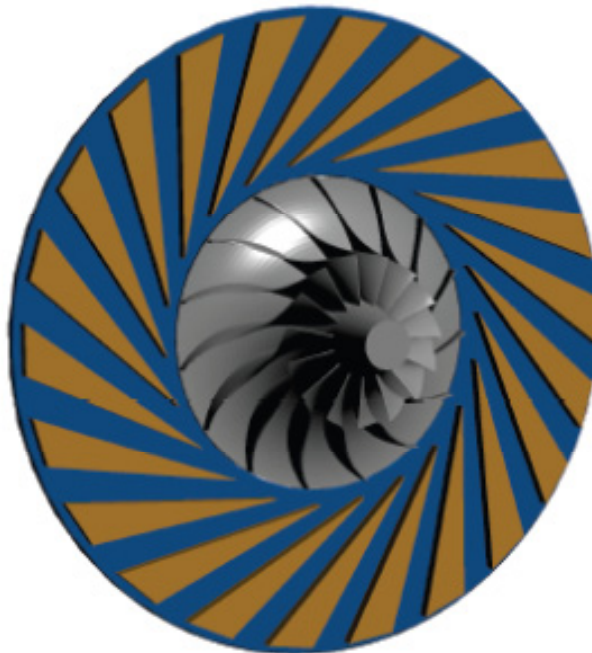
Fig. 119 - Vista prospettica dello stadio ottimizzato – massimizzazione Rendimento Politropico
