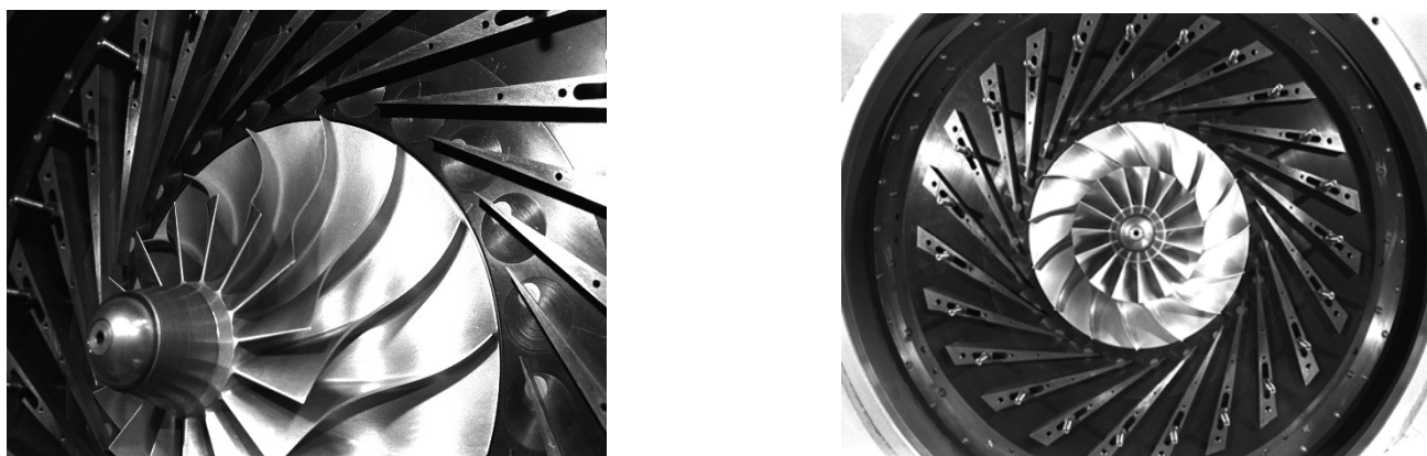
Fig. 1 - Stadio del compressore centrifugo - parete frontale rimossa [1]
