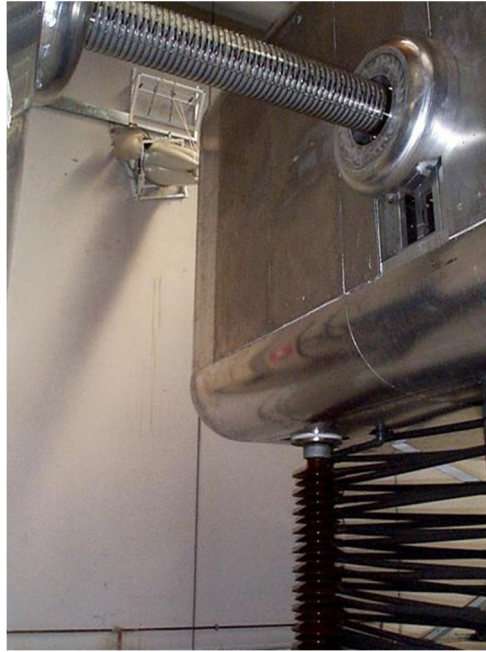
Fig2.5: Esempio di tubo acceleratore piattaforma ECR LNL-INFN
