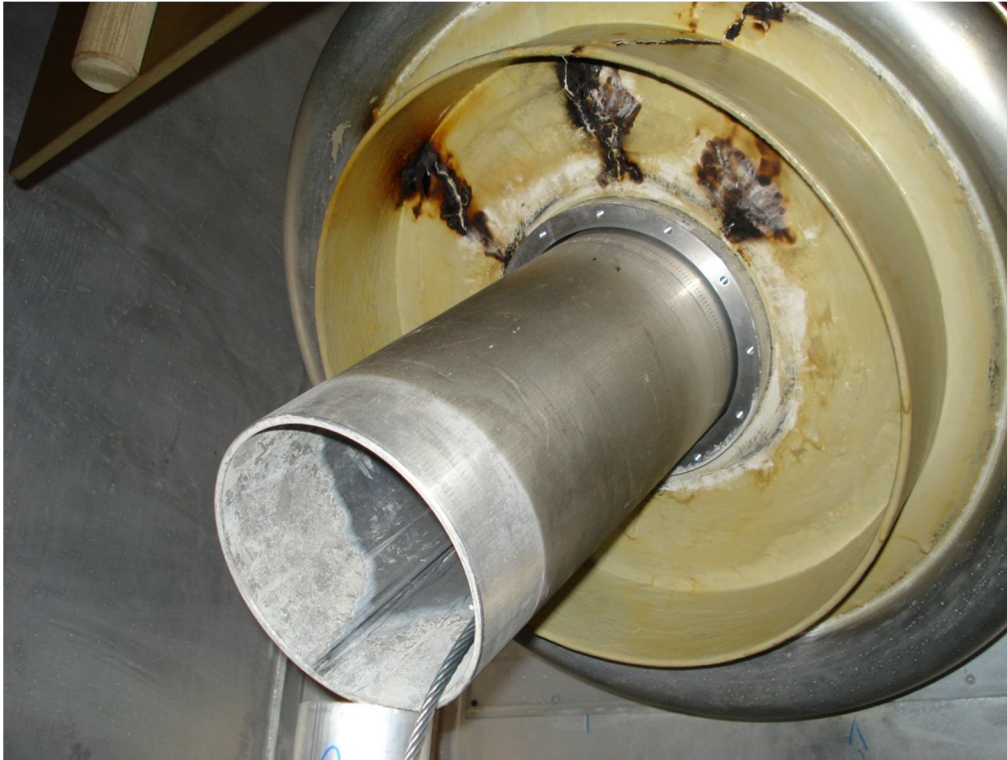
Fig.5.1:Scariche superficiali su condotto il alta tensione modello CERN
