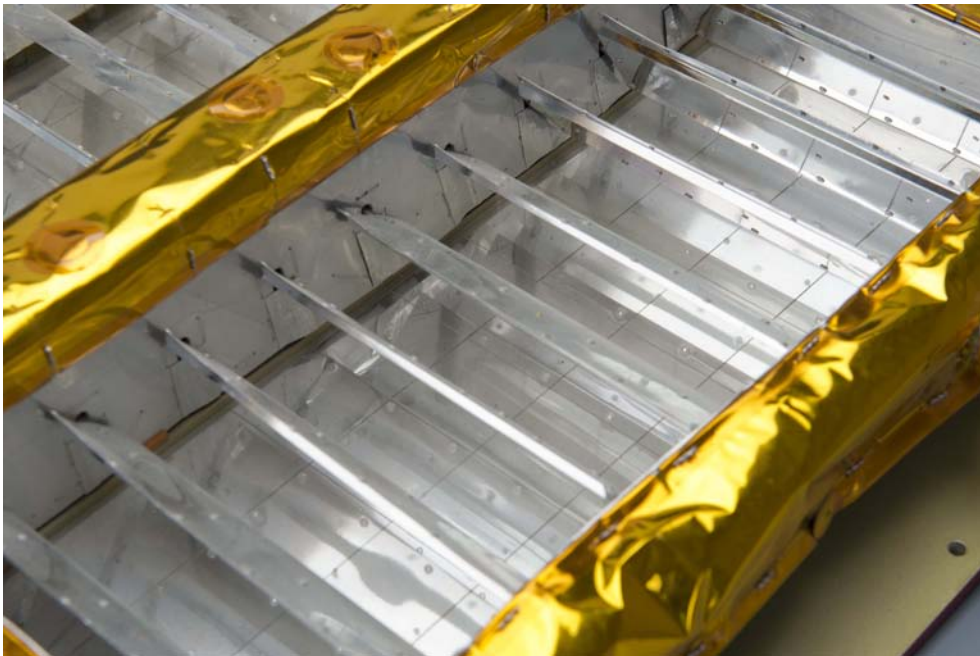
Figure 1.5: Picture of the Rosetta thermal louvers. Copyright ESA-A. Le Floc'h
