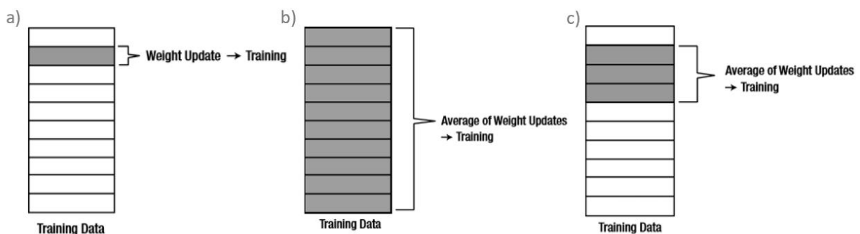
Figura 3.8. Rappresentazione dei metodi di: a) discesa stocastica del gradiente; b) batch; c) mini-batch. Gli elementi evidenziati in grigio rappresentano il numero di elementi che vengono utilizzati in contemporanea per aggiornare i pesi [78].
