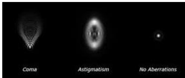
Figura 2.5. Due esempi di aberrazioni extra-assiali, il come e l'astigmatismo, confrontati con un'immagine senza aberrazioni [53].
