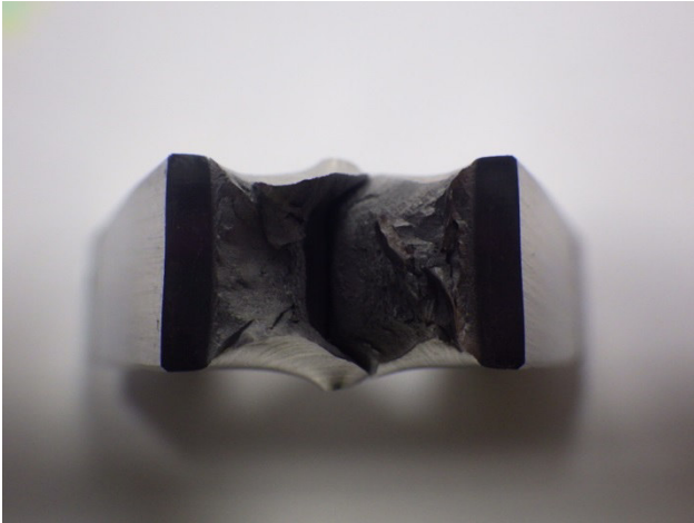
Fig.41 Sezione provino non trattato rotto a -46°C
