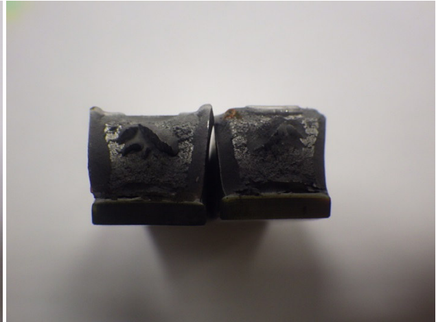
Fig.42 Sezione provino trattato rotto a -46°C
