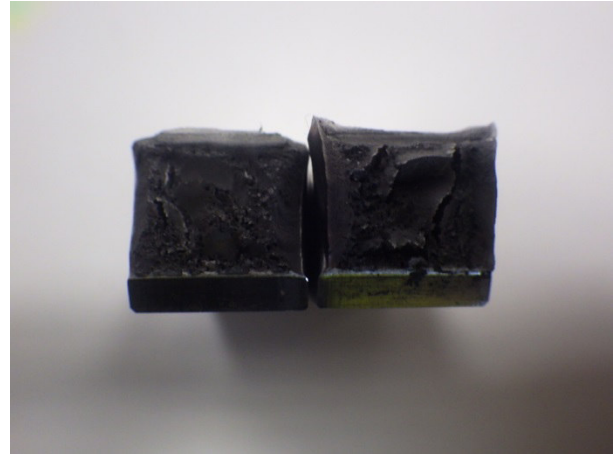
Fig.32 Sezione provino trattato rotto a 20°C
