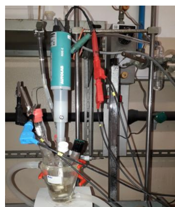
Figura 2.19: A sinistra, elettrodo a disco rotante (Metrohm) con puntale per RDE; 60 a destra, cella con RDE, usato come elettrodo lavorante per gli studi riguardanti la reazione di attivazione.
