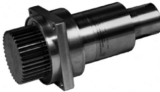
Figura 7.1.2: Smorzatore ECD: versione con riduttore di velocità (da Rif. [10])
