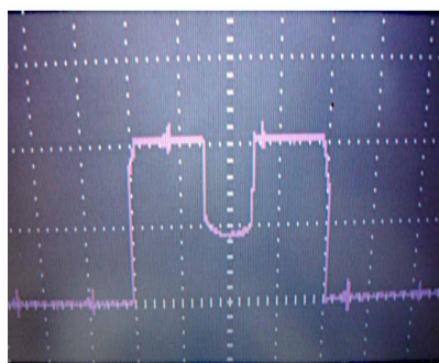
Figura 4.3 Segnale analogico proveniente dalla telecamera
