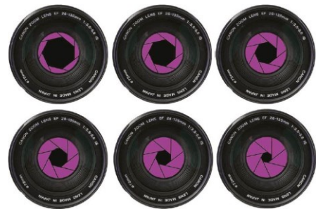
Figura 4.3 In alto (da sinistra a destra): f/4, f/5.6, f/8; in basso: f/11, f/16, f/22.
