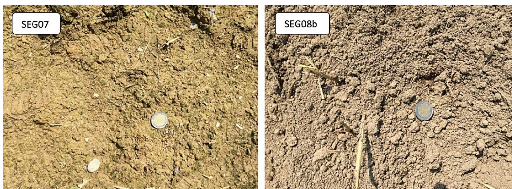
Figura 25. Foto dei target di suolo nudo misurati durante la campagna di acquisizione delle firme spettrali: a sinistra il campione SEG07, mentre a destra il campione SEG08b. Notare la netta differenza di colore tra i due suoli, legata principalmente al diverso contenuto idrico.
