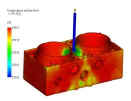
(d) Increase the diameter of the sprue, temperature at 270  $^{\circ}\mathrm{C}$
