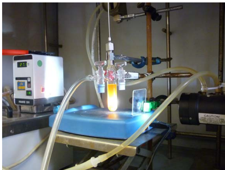
Figura 2.1. Apparato sperimentale allestito per le reazioni di ossidazione fotoindotta dell'acqua.
