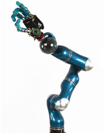
Figura 22 Light-weight robot con mano di presa (DLR)
