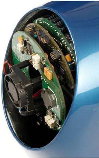
Figura 38 Integrazione hardware all'interno del modulo link-giunto. Si possono distinguere, dall'esterno verso l'interno, l'unità di alimentazione elettrica, la scheda per il controllo del motore e giunto e l'unità elettrica di potenza
