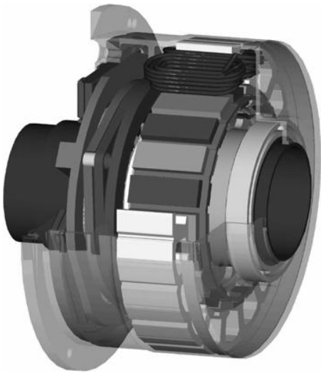
Figura 39 RoboDrive sviluppato da DLR. Si vedono chiaramente i poli dello statore separati e avvolti separatamente
