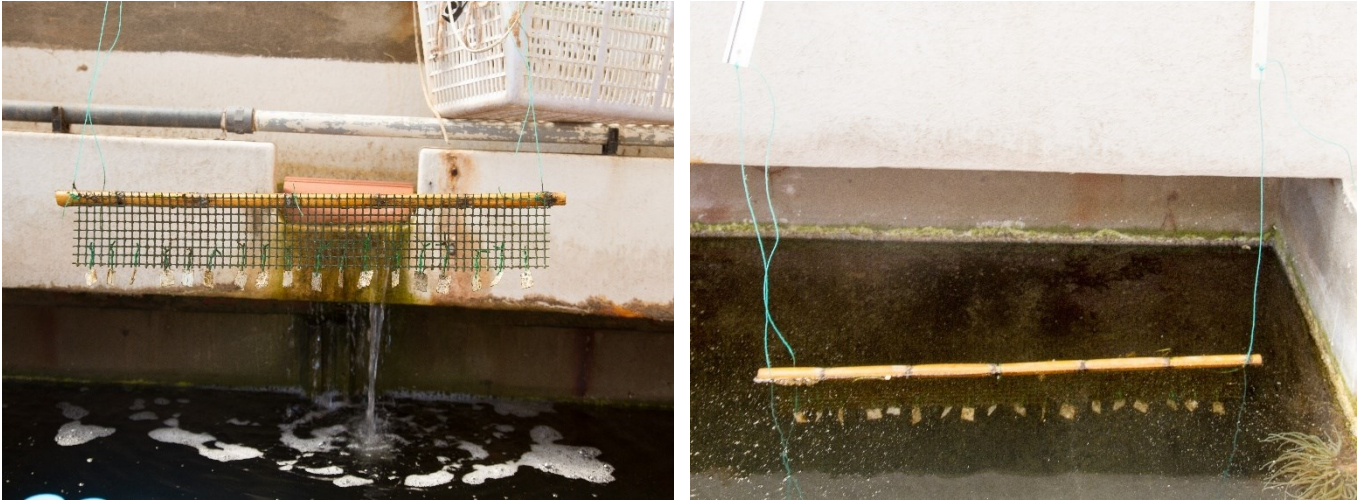
Fig 3.25. Telaio utilizzato per l'immersione in acqua di mare dei campioni
