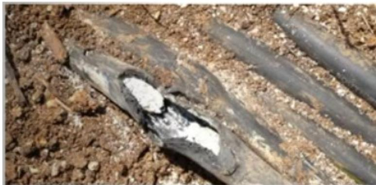
*Figura 3.2 – Guasto con separazione del conduttore in due parti*
