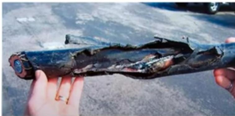
*Figura 3.1- Tratto di cavo guasto a seguito di un cortocircuito*
