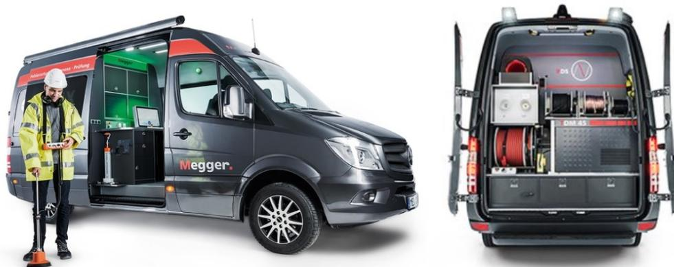
*Figura 4.19 - Sistema su laboratorio mobile Centrix 2.0*
