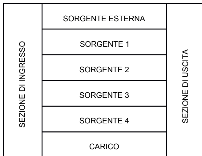
Figura 5.12: Sezioni del quadro per Smart Grid
