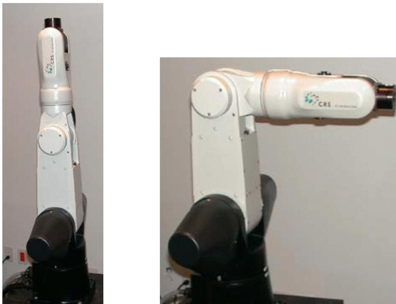
Fig. 2.13: Thermo CRS A45 - Posizione di zero dei giunti: *Carldy position* e *Ready position*
