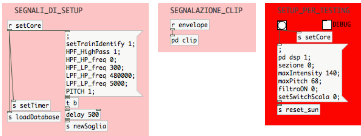
Figura 2.4: Segnali di configurazione della patch SoundRiseCore.pd
