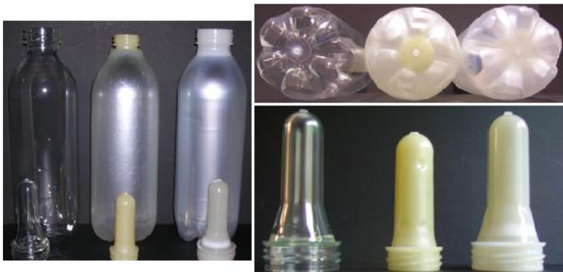
Figura 6.35 – Immagini delle bottiglie realizzate mediante stretch blow molding con un impianto pilota: a sinistra sono rappresentate le bottiglie con le preforme (bottiglia in PET, in PET/EVOH 90/10 parzialmente degradato e in PET/EVOH 95/5 non degradato), a destra sono visibili i dettagli del fondo bottiglie e delle preforme
