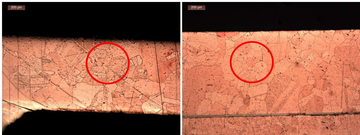
FIGURA 12: DIMENSIONE GRANA CRISTALLINA PRE-SALDATURA (SINISTRA), DIMENSIONE GRANA CRISTALLINA POST-SALDATURA (DESTRA)
