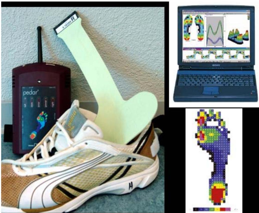
**Figura 4.4** Suoletta Pedar e immagini dell'interfaccia operativa
