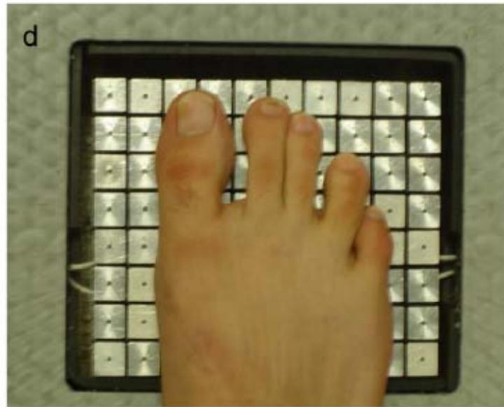
**Figura 4.11 – pedana che quantifica gli sforzi tangenziali con una matrice di sensori piezoelettrici**
