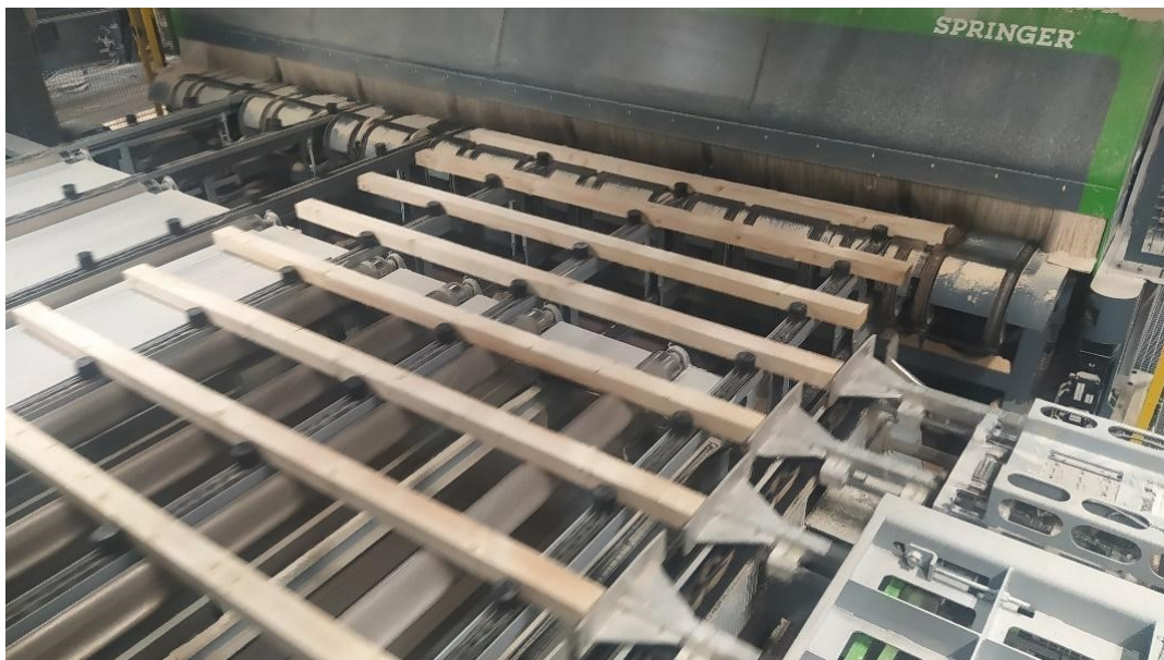
Figura 2-5: Successivamente le tavole passano sotto ad un sistema di seghe circolari, in questo caso macchina tagliante Springe, con potenza di 35 MW ciascuna per il taglio (foto di Leonardo Cusinato, Wilburgstetten, Germany)
