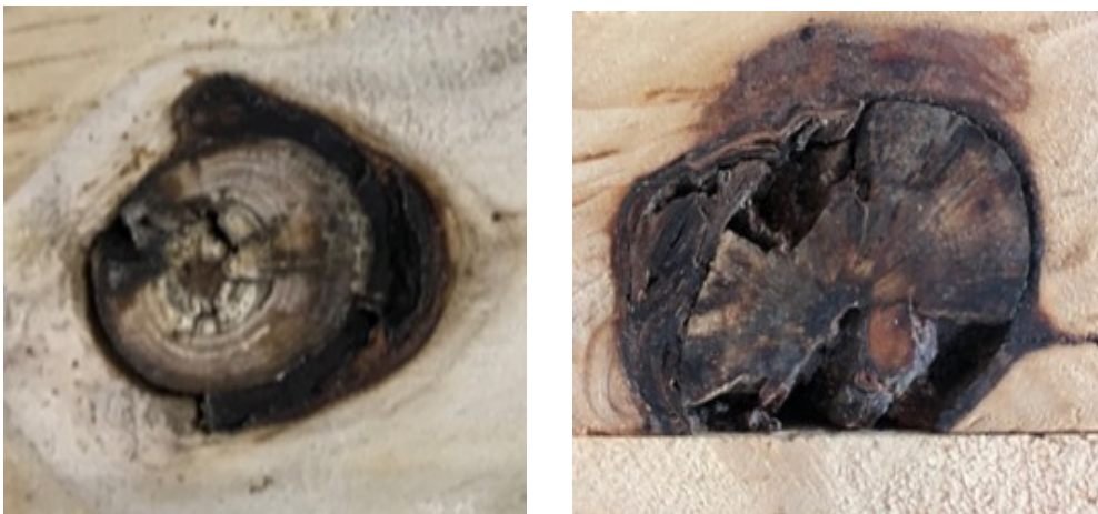
Figura 4-3: esempio di nodo barkringed a sinistra e nodo marcescente a destra (foto di Leonardo Cusinato, Microtec)
