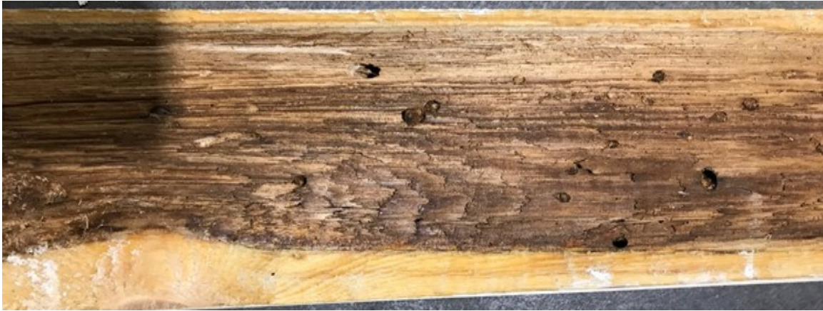
Figura 4-5: esempio di carie bruna su tavole asciutte (foto di Leonardo Cusinato, Microtec)
