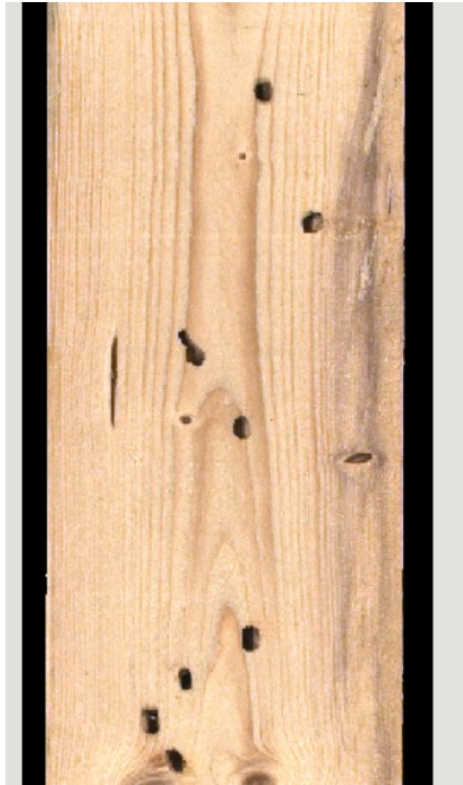
Figura 4-6: esempio di legno forato da attacco di xilofagi visto dallo scanner sottoforma di immagine .xml (foto di Leonardo Cusinato, Microtec, immagine di scansione)
