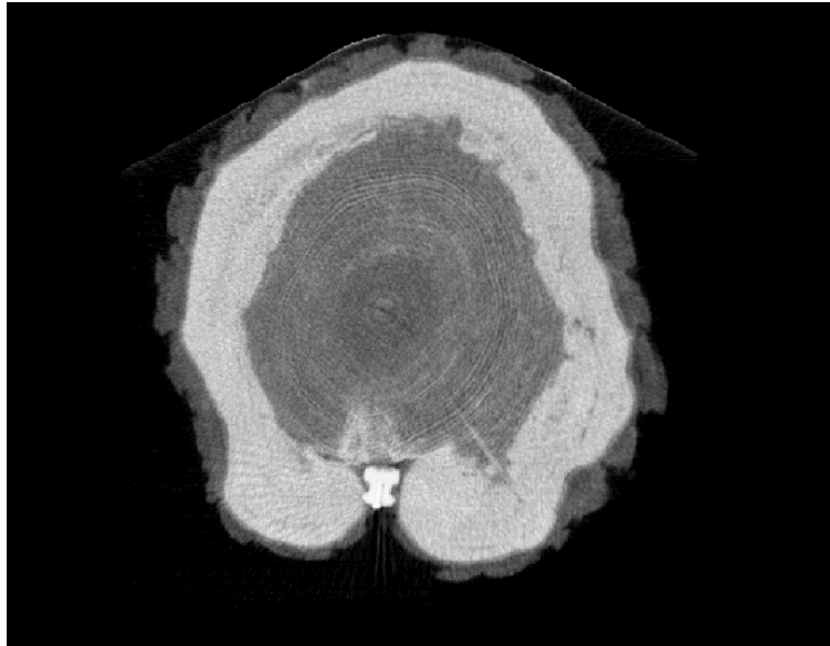
Figura 3-3: tomografia del tronco fatta con il CT Log; si nota la zona bianca (più densa) con la presenza di un corpo metallico (immagine di Leonardo Cusinato, Microtec)
