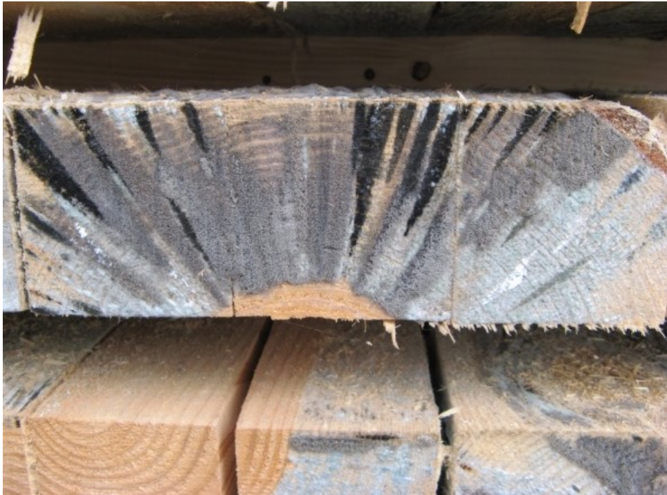
Figura 4-4: esempio di azzurramento su tavole asciutte (foto di Leonardo Cusinato, Microtec)
