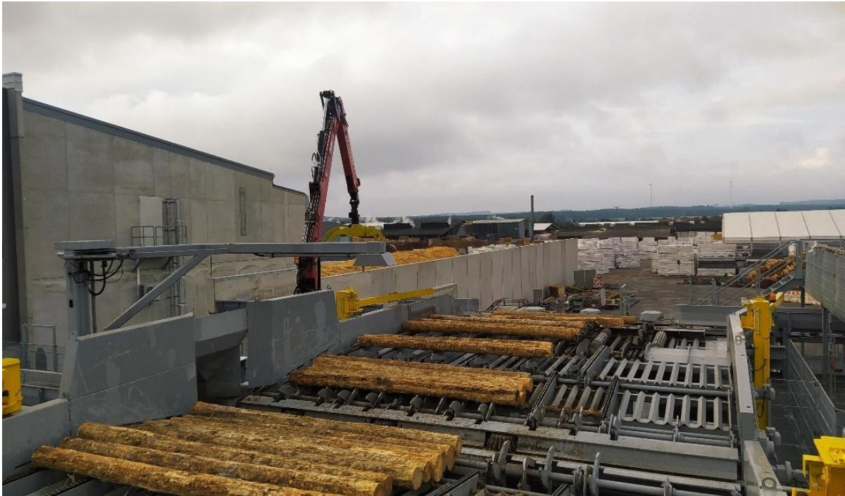
Figura 2-3: scortecciatrice esterna con braccio meccanico nell'impianto Rumplmeier (foto di Leonardo Cusinato, Wilburgstetten, Germany)
