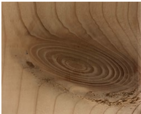
Figura 4-1: esempio di nodo vivo (foto di Leonardo Cusinato, Microtec)
