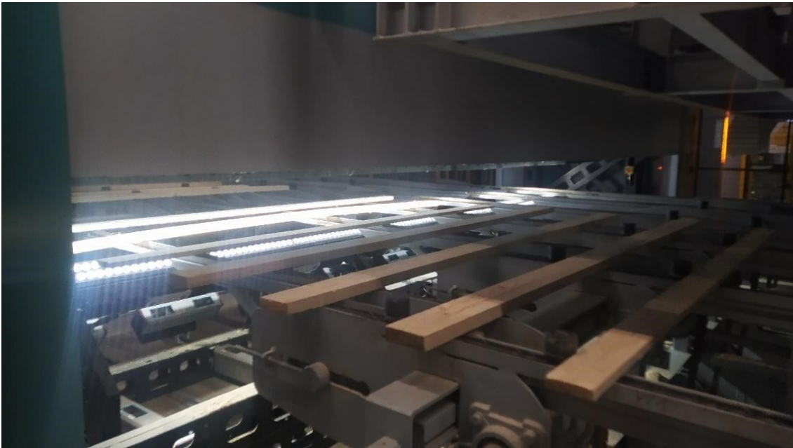
Figura 2-4: Inizialmente le tavole passano sotto il controllo dello scanner, in questo caso scanner trasversale Microtec GoldenEye 900, che li classifica in base ai difetti e ne costruisce uno schema di taglio ottimale (foto di Leonardo Cusinato, Wilburgstetten, Germany)
