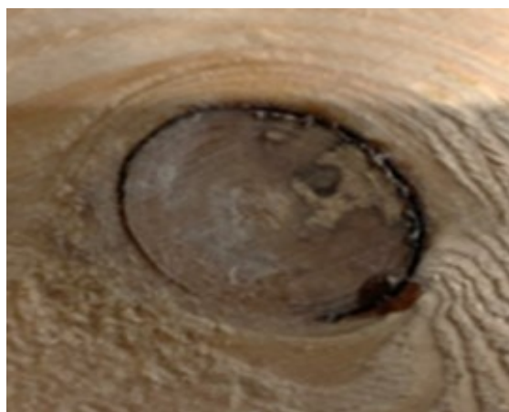
Figura 4-2: esempio di nodo vivo (foto di Leonardo Cusinato, Microtec)
