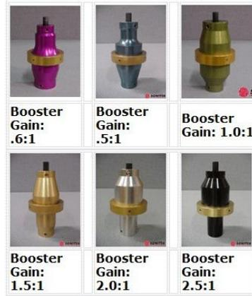
Figura 15: Esempio di booster differenti
