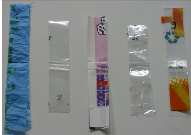
Figura 72: Esempio di provini per prova a trazione
