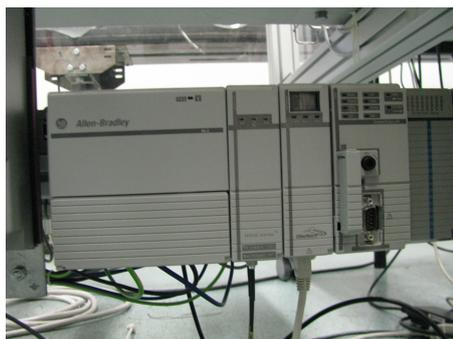
(a) Sistema di controllo Rockwell Automation serie Compact Logix.
