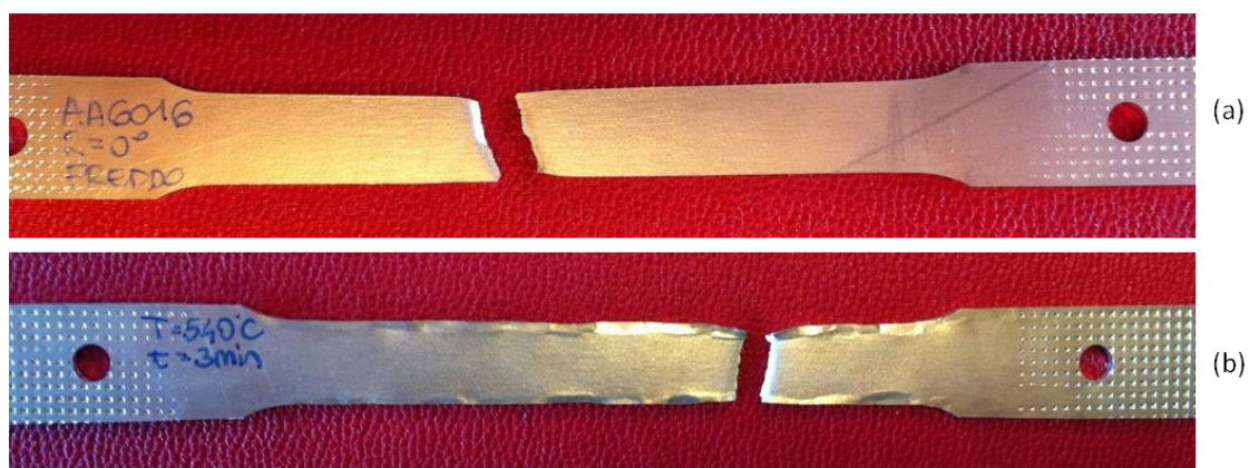
Figura 14 - Campioni post test di trazione (a) materiale tal quale (b) materiale trattato termicamente
