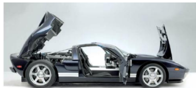
Figura 10 - Ford GT: carrozzeria in lega d'alluminio realizzata mediante il processo SPF [7]
