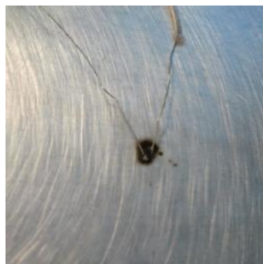
Figura 26 - Particolare delle estremità della termocoppia saldate al provino
