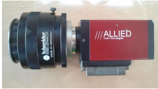
Figura 16 - Fotocamera ad alta frequenza adottata per monitorare la deformazione durante la prova di trazione
