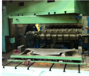
Figura 9 - Lamiera estratta dal forno e posta sullo stampo inferiore della pressa
