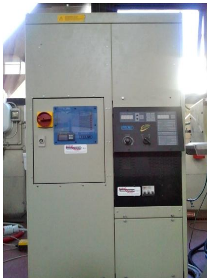
Figura 15 - Induttore Felmi Egma adottato per il riscaldamento del provino
