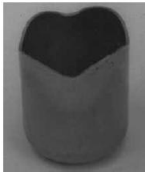
Figura 11 - Tipiche orecchie in un componente imbutito [1]
