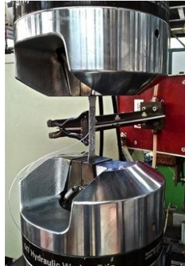
Figura 14 - Testa di riscaldamento posta vicino al campione durante la prova per attuarne il riscaldamento localizzato
