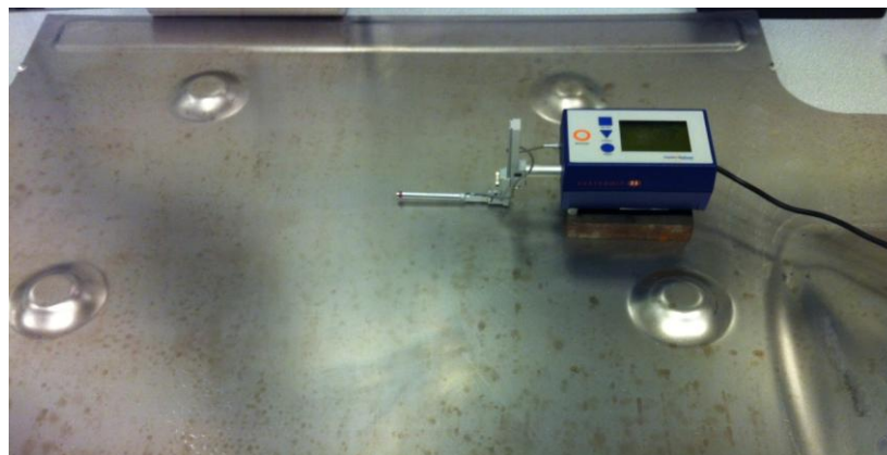
Figura 30 - Rugosimetro posizionato sul componente
