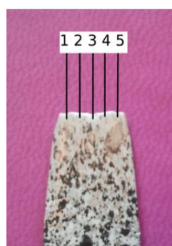
Figura 49 - Posizione dei punti di cui si è misurato lo spessore del campione in esame
