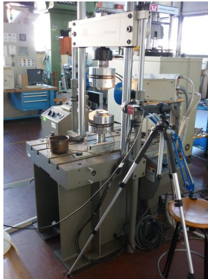
Figura 13 - Macchine per prove di trazione, MTS_322
