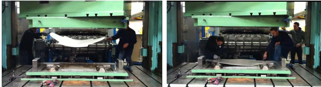
Figura 4 - Istanti successivi dell'operazione di movimentazione manuale della lamiera dal forno alla pressa
