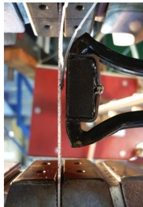
Figura 28 - Posizionamento corretto della testa dell'induttore sul provino da riscaldare per un perfetto controllo della temperatura impostata
