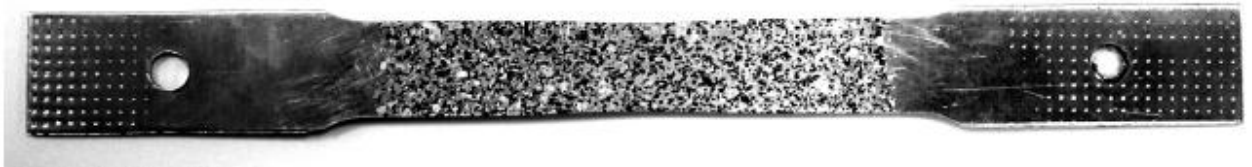
Figura 25 - Pattern colorato sulla superficie del provino
