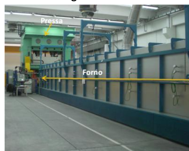
Figura 6 - Sequenza del posizionamento di forno e pressa
