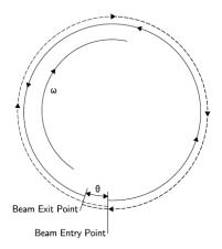
Figura 6: Giroscopio a fibra ottica
