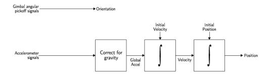
Figura 3: Algoritmo del sistema a piattaforma stabilizzata
