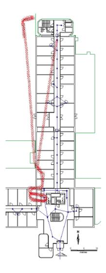
Figura 10: Deriva di orientamento e posizione
