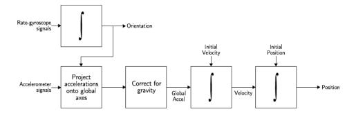
Figura 4: Algoritmo del sistema strapdown
