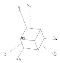
Figura 1: Il body frame e il global frame
