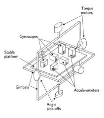
Figura 2: Sistema a piattaforma stabilizzata
