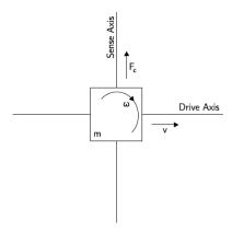
Figura 7: Giroscopio a massa vibrante
