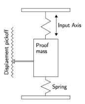
Figura 8: Accelerometro meccanico
