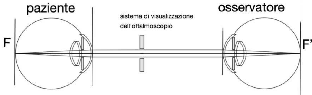
Figura 16. Schema ottico del sistema di visualizzazione fra due occhi emmetropi
