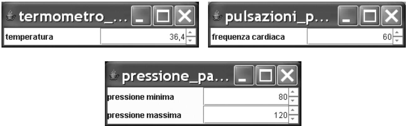
Figura 6.1.2: Interfacce del termometro, del cardiofrequenzimetro e dello sfigmomanometro
