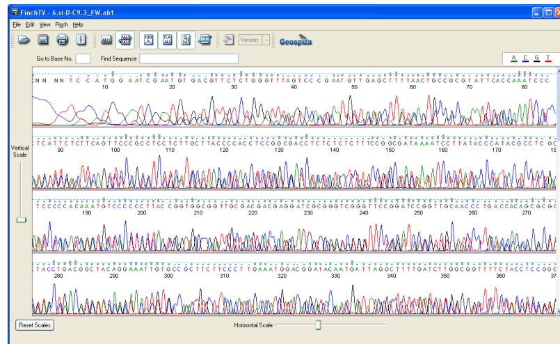
Figura 4.18: picchi doppi di uguale intensità lungo l'intero Analyzed Data. La sequenza è D
