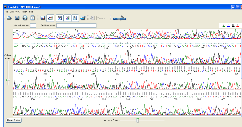
Figura 6.17: sequenza “AP5THRREV.ab1”. I primi 220 picchi sono multipli (TD-D), successivamente i picchi multipli calano di intensità. L'algoritmo classifica la sequenza come FD.
