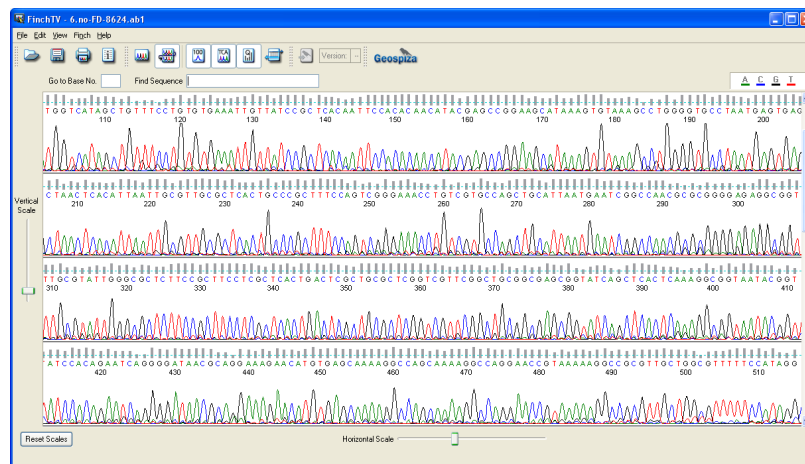
Figura 4.19: picchi doppi di diversa intensità lungo l'intero Analyzed Data. La sequenza è FD
