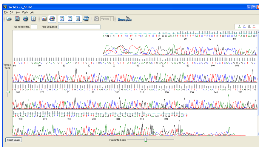
Figura 5.3: AD ottenuto dal sequenziamento dello stesso campione di DNA della figura 5.2. Si osservano picchi multipli lungo tutta la sequenza.
