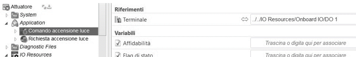
Figura 4.31: Porta DO1 usata come terminale del "Comando accensione luce".
