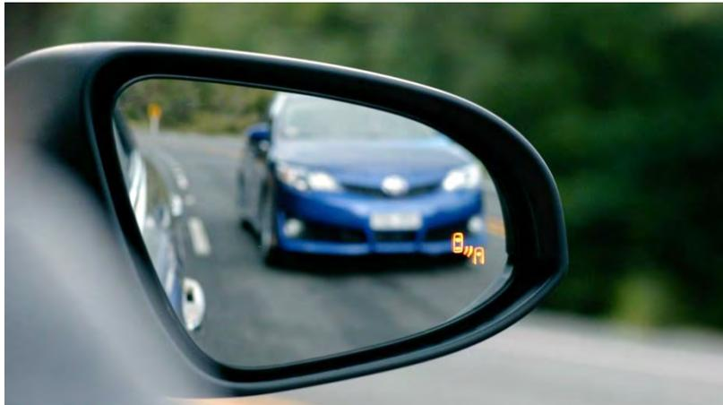
Figura 1.10 Indicatore di presenza di un'autovettura nell'angolo cieco (Toyota, 2014)
