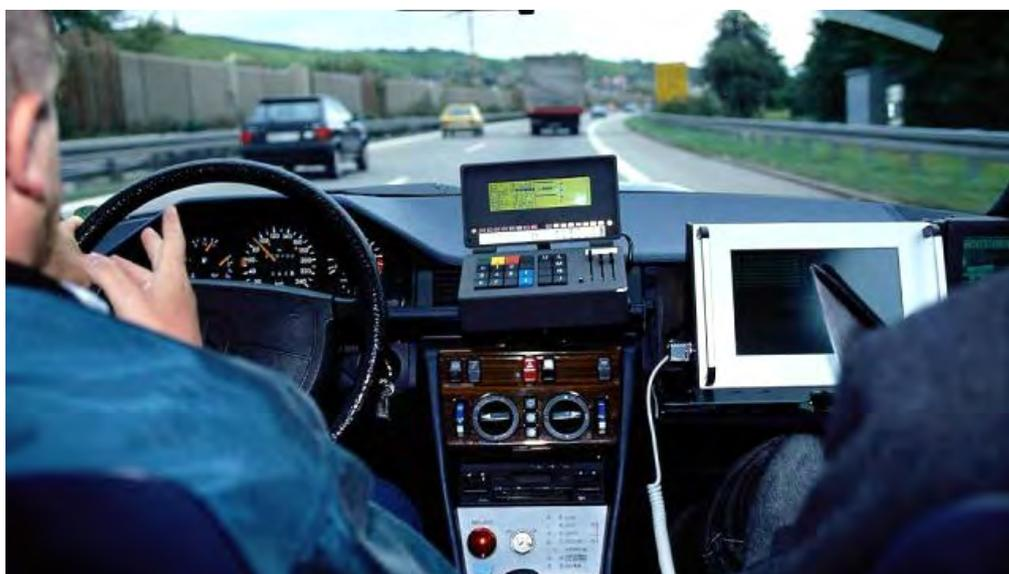
*Figura 1.1* Test di guida di un veicolo a guida automatica del progetto PROMETHEUS (Mercedes, 2014)
