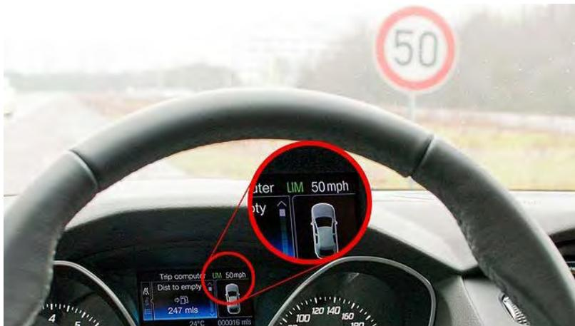
*Figura 1.12* Indicazione dei limiti di velocità sul cruscotto della vettura (Google, 2014)
