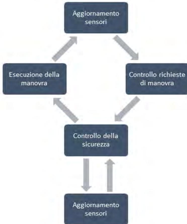
*Figura 2.7 Struttura del Regulation layer*
