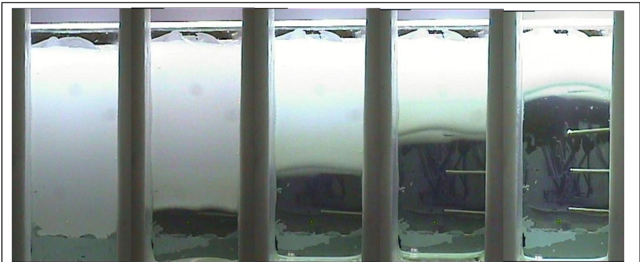
Figura 4-39. Progressione temporale della prova con paraffina 5203 e potenza di 20 W: le immagini sono state scattate rispettivamente a 0, 20, 30 40, 50 minuti dall'inizio della prova.
