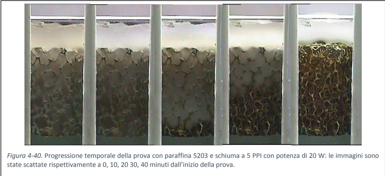
In Figura 4-41 sono riportate le immagini tratte dal video per la prova effettuata con paraffina 5203 e schiuma a 5 PPI con potenza di 20 W. Si nota come il tempo richiesto per la fusione completa del PCM sia inferiore rispetto al caso senza schiuma, in quanto si passa da 50 a 40 minuti, con una riduzione quindi del 20%. Inoltre, come già illustrato precedentemente, a ciò si accompagna una diminuzione marcata della temperatura della base di rame.
