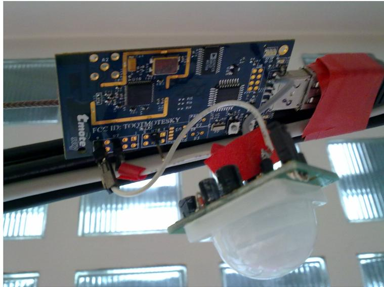
Figura 2.6: Immagine del collegamento fra il TelosB e il PIR
