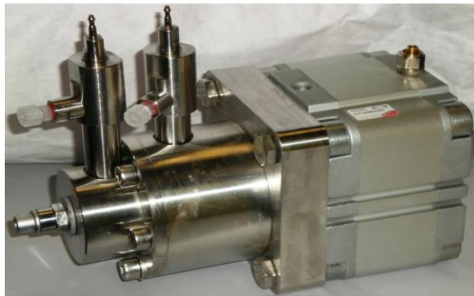
Figura 3.7- Parte del bioreattore a perfusione per applicare cicli di pressione idrostatica (camera di coltura, attuatore pneumatico e valvole idrauliche).
