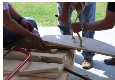
Figura 5.16 Incernieratura della pala al remo (foto De Vescovi, 2011)
