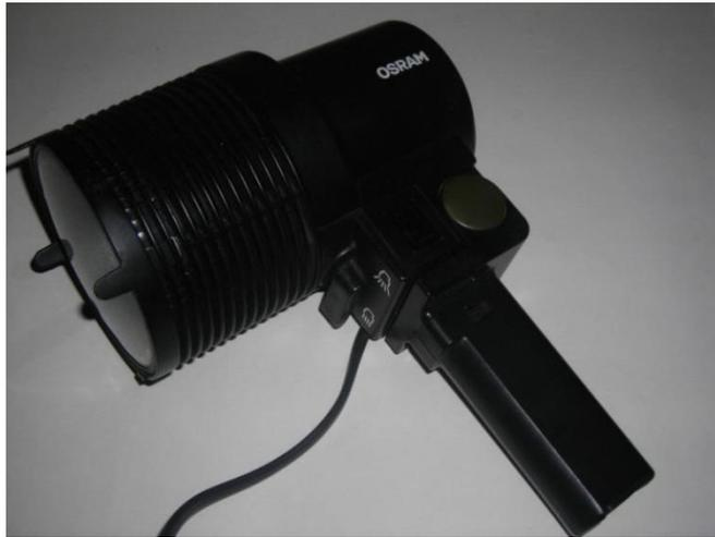
Figura 3.5: faro alogeno Osram, modello SLV1000, utilizzato nelle prove.
