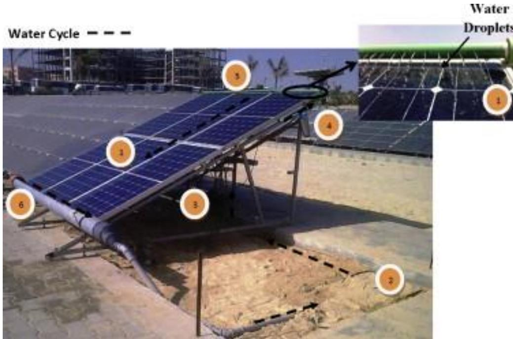
Figura 2.4: configurazione dell'esperimento di Moharram et al.: 1) modulo fotovoltaico; 2) serbatoio; 3) pompa; 4) filtro; 5) fori; 6) grondaia.
