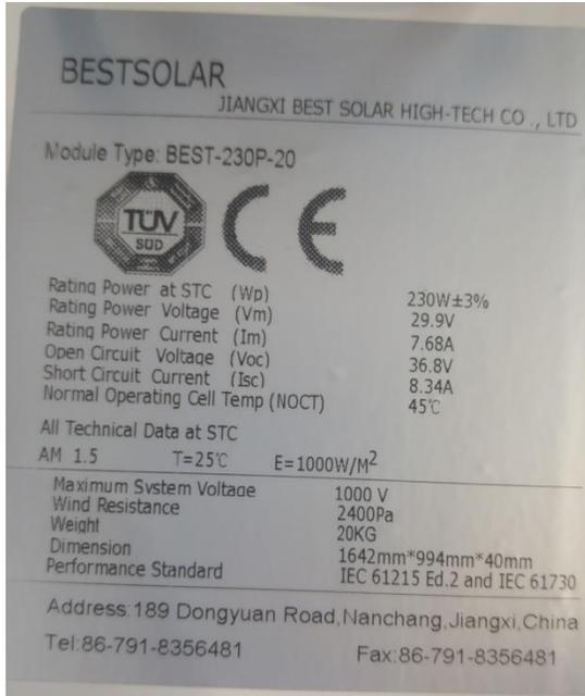
Figura 3.1: specifiche del pannello utilizzato.
