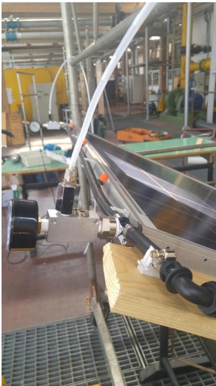
Figura 3.9: in alto la vista frontale dell'apparato sperimentale completo, in basso il dettaglio del bordo superiore del pannello, si riconoscono i 3 ugelli e i 2 manometri.
