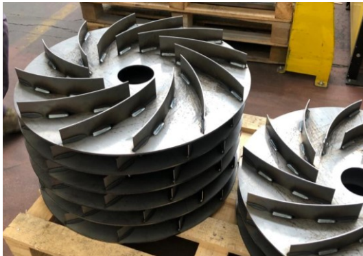
Fig.2.14 Disco e pale saldate insieme
