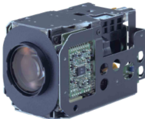
Figura 6.5: Videocamera dell'Ulisse Compact: Sony FCB-EX480CP
