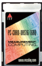
Figura 1.8: Scheda di acquisizione PC-CARD-DAS 16/16AO
