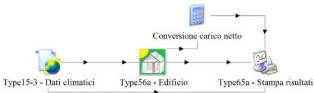
**Figura 4.5: Modello in Trnsys per la determinazione del fabbisogno energetico netto di riscaldamento dell'edificio**
