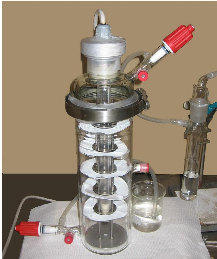
**Figura 5.2.** Reattore impiegato per i test di fotocatalisi
