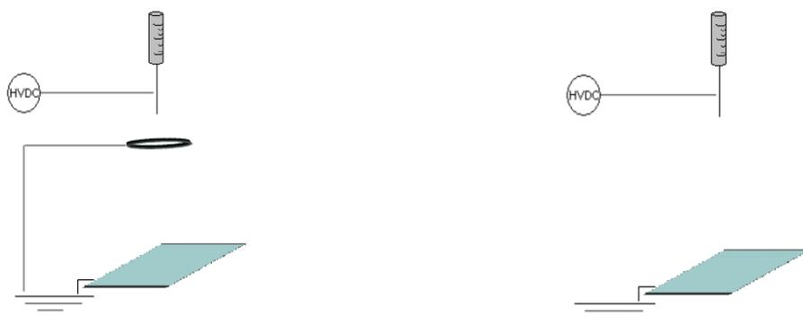
**Figura 3.7.** Schema dell'impianto di *electrospraying* con elettrodo aggiuntivo (sinistra) e senza elettrodo (destra)
