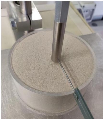
**Figura 3.6** Una foto durante la misurazione tramite calibro della distanza bordo-cilindro.
