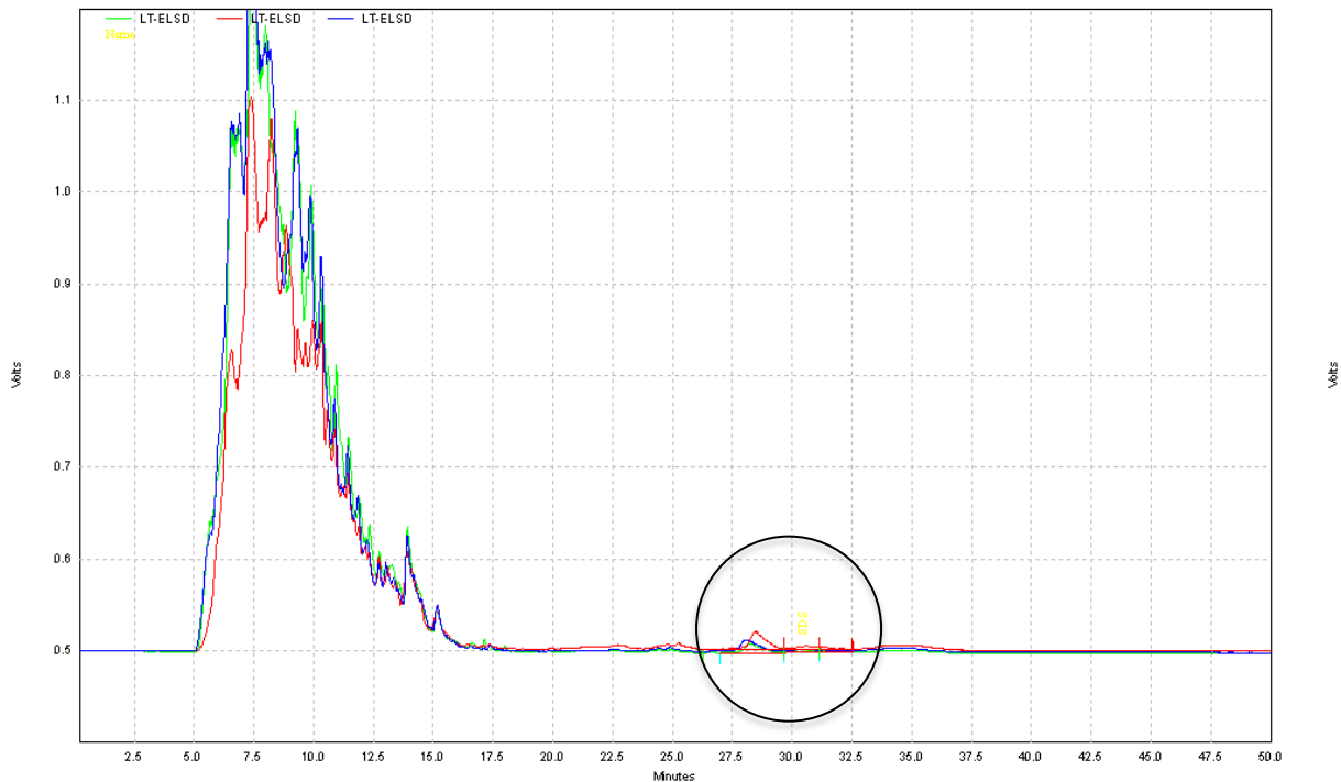
Figura 4.11: 3 Analisi cromatografiche RP-HPLC di campioni trattati con metodo Haverich filtrati e sonicati con le condizioni: colonna: Vydac C18 218TP 5 \mu Polymeric; flusso 1 ml/min; eluente A: 0,05% TFA in H 2 O MilliQ; eluente B: 0,05% TFA in CH 3 CN; gradiente: prima da 0% di eluente B a 40% di eluente B in 20 minuti poi da 40% di eluente B a 70% di eluente B in 30 minuti; lettura con detector ELS. In alto a destra ingrandimento del particolare cerchiato: picco corrispondente al detergente.
