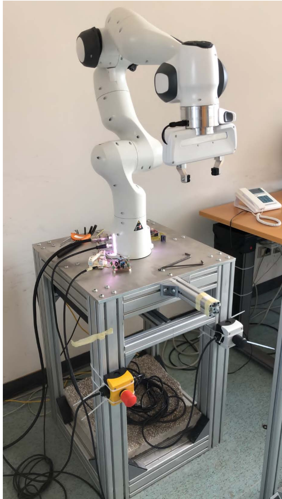
Figura 10: Supporto del robot.
